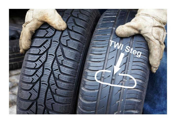
Der Verschleißanzeiger auch Treadwear Indicator oder TWI genannt findet man an sechs Stellen des Reifenumfangs.
